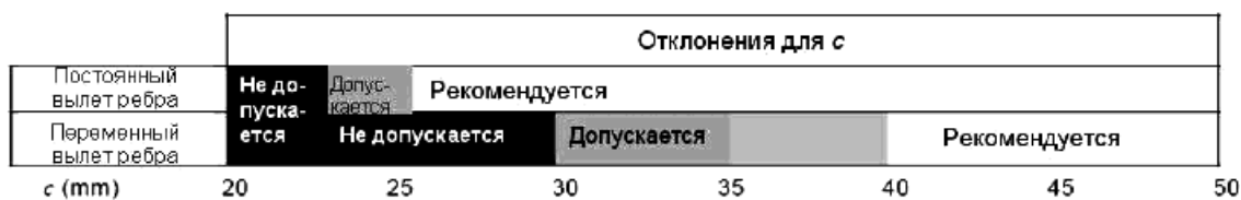
Рисунок 10 - Межреберное расстояние разных типов изоляторов
