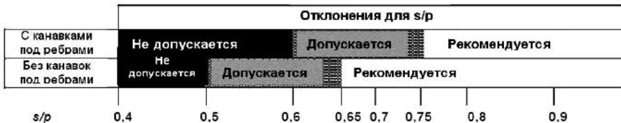
Рисунок 9 - Зависимость межреберного расстояния от вылета ребра (s/p)
