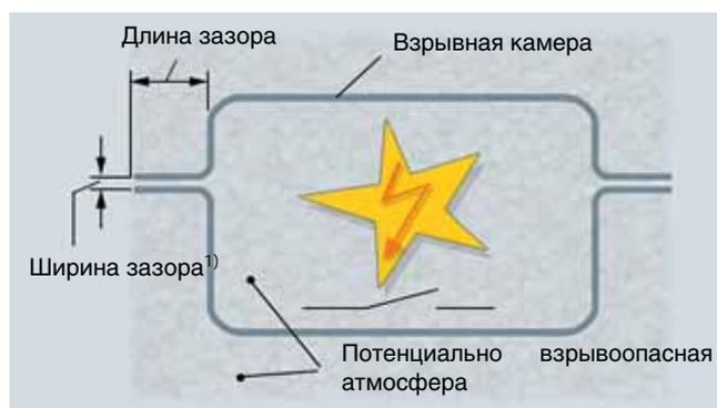
1) Предельная ширина зазора это ширина зазора между двумя параллельными поверхностями фланца взрывной камеры длиной 25 мм, при которой воспламенение внутри камеры не передается за ее пределы.
