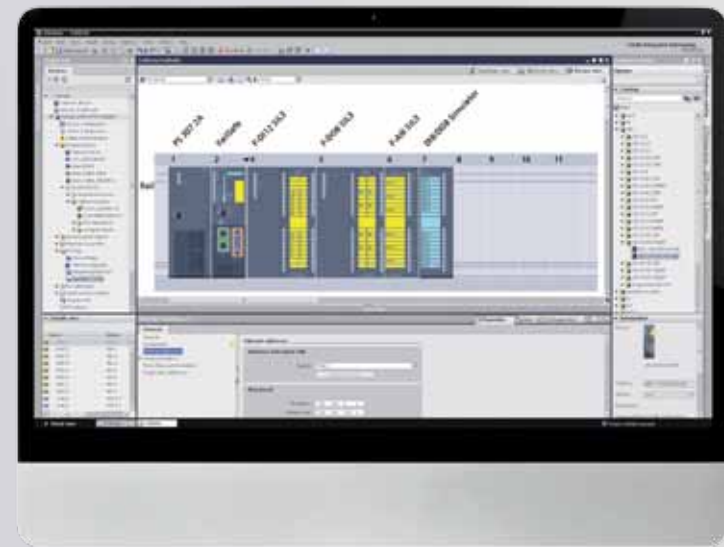
Аппаратный вид корзины S7-300 с Safety I/O модулями
