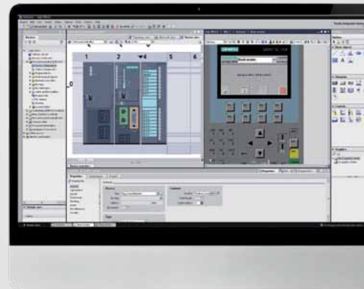
Открыты аппаратная структура контроллера и имитатор панели Comfort Panels
