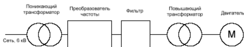
Рисунок 4 - Двухтрансформаторная схема использования низковольтного преобразователя частоты
